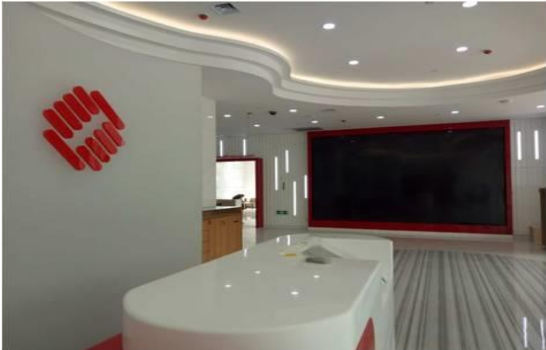
采用 LG55 寸屏幕，单屏重量 20KG，拼缝 1.8mm
