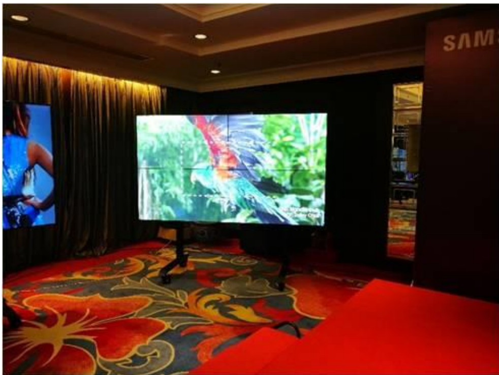
采用三星 2x2 拼接屏，拼缝 1.7mm
